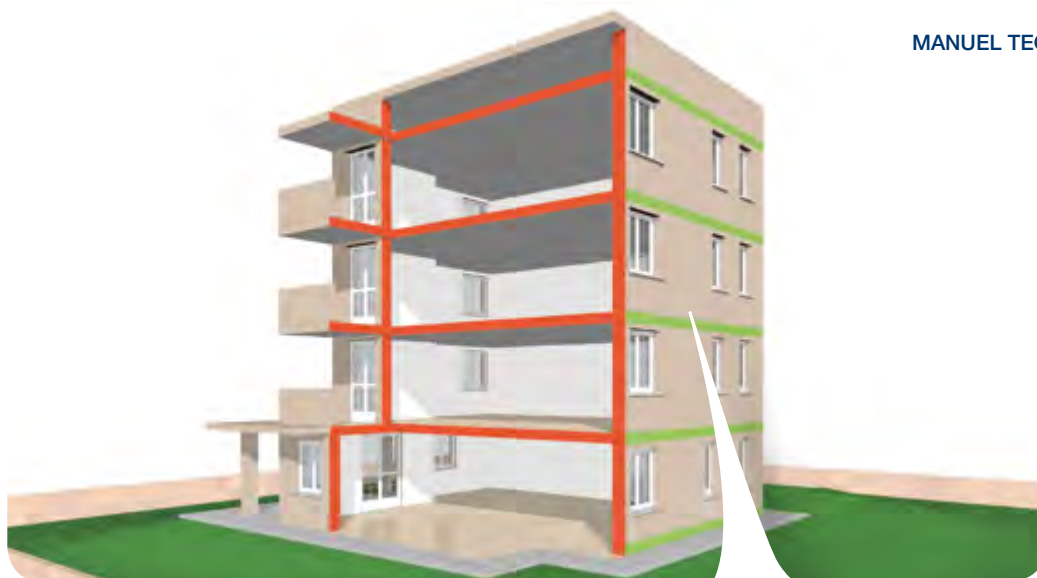
Disposition des bandes filantes sur des façades aveugles
